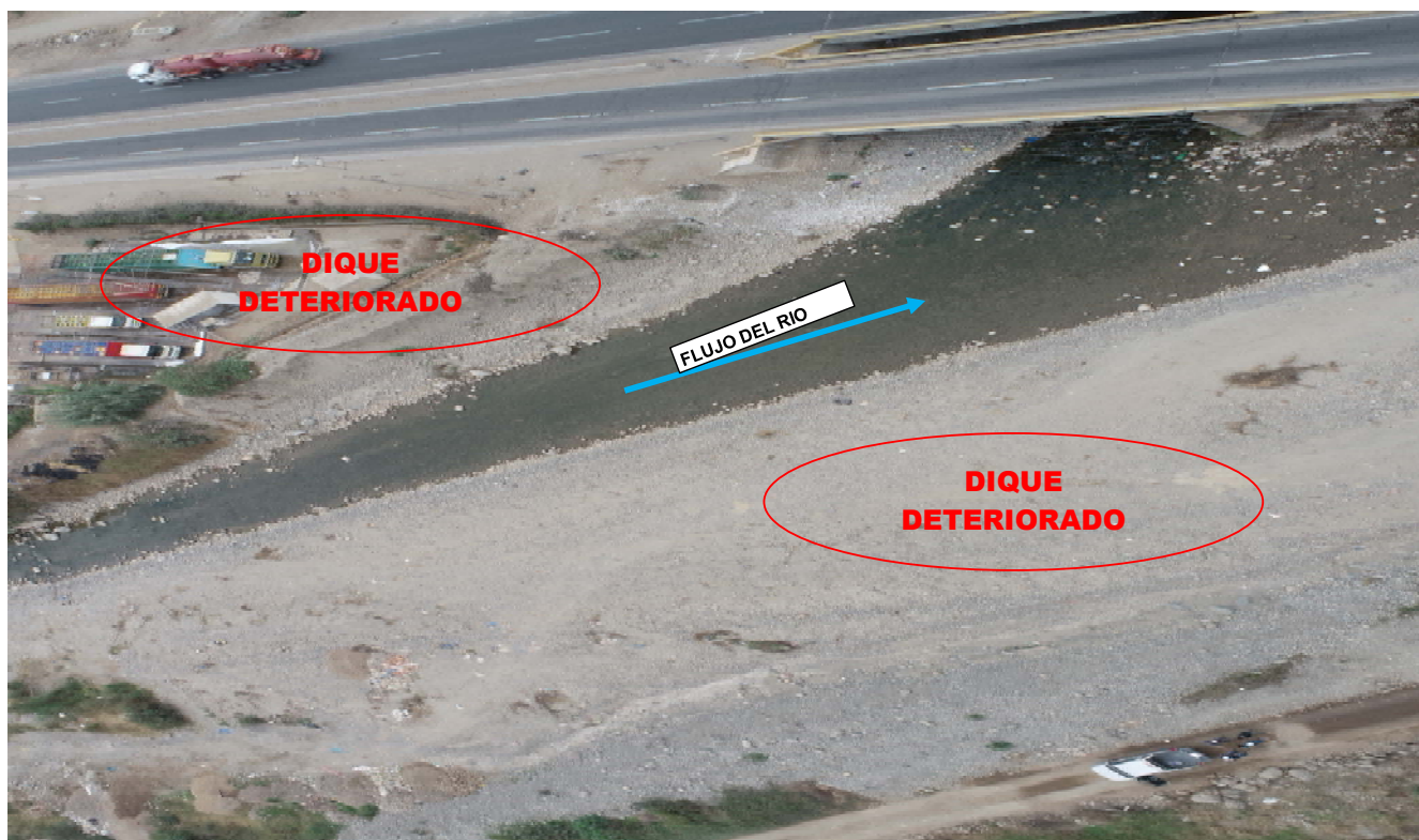
FIGURA N°02: MATERIAL COLMATADO EN EL CAUCE DEL RÍO CHANCAY-HUARAL, CON UNA PROFUNDIDAD PROMEDIO DE 1.0 M Y DIQUE DETERIORADO. ESTO PROVOCA QUE DESBORDAMIENTO DEL RÍO SEA MAS INMINENTE.
