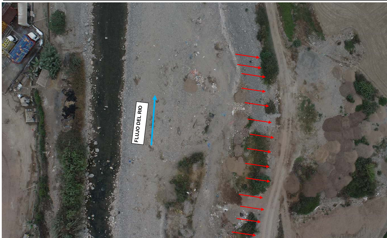
FIGURA N°03: EN LA TEMPORADA DE MAXIMAS AVENIDAS EL RÍO CHANCAY-HUARAL, SE DESBORDA, POR LA MARGEN DECHECHA, EN EL SECTOR SALINAS BAJO-PUENTE CHANCAY, DISTRITO DE CHANCAY, CUYO TRAMO SE ENCUENTRA COLMATADO Y DESPROTEGIDO,
